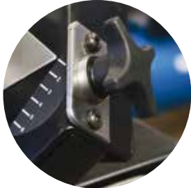
Grinding wheel wear adjustment Compensation usure de la meule Compensación del desgaste de la muela
