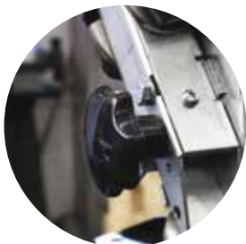
Working angle adjustment Réglage angle de travail Ajuste del ángulo de acción
